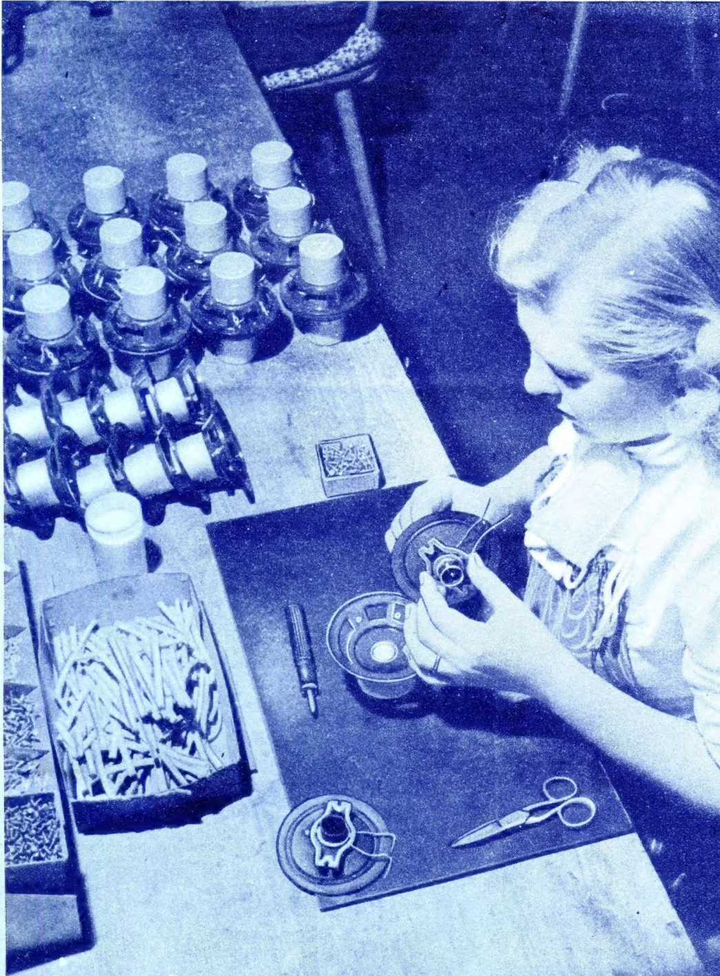
In Reisesuperhets werden hochwirksame permanentdynamische Lautsprecher eingebaut, die sich durch kleine Abmessungen und geringes Gewicht auszeichnen, trotzdem aber ein relativ breites Frequenzband wiederzugeben vermögen. Unser Bild zeigt einen Ausschnitt aus der Lautsprecherfertigung (Einsetzen der Lautsprechermembran mit Zentrierspinne) (Werkfoto: Grundig-Stumpf)
